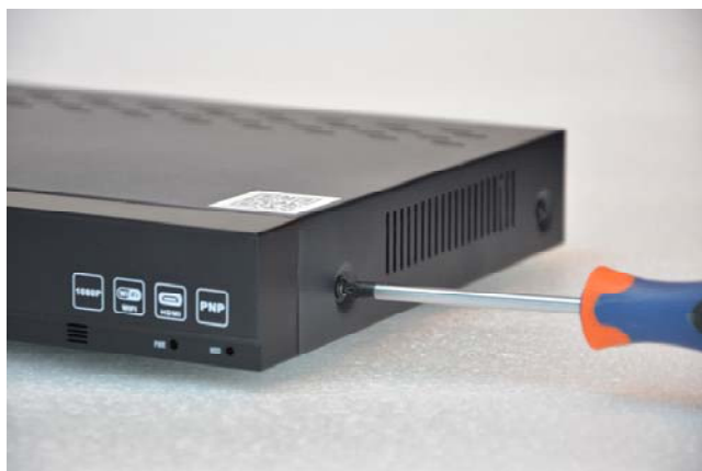
Rimuovi il coperchio svitando le 5 viti: 2 per lato e una posteriore
